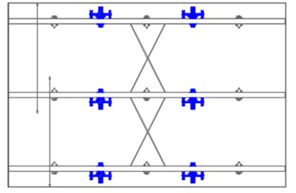
FOR TWO TRUSS FLY FORM MORE THAN 50' LONG USE SIX MECHANICAL JACK DOLLIES FOR THREE TRUSS FLY FORM MORE THAN 50' LONG USE NINE MECHANICAL JACK DOLLIES
