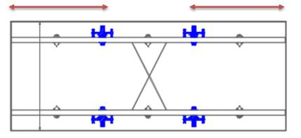
FOR TWO TRUSS FLY FORM 50' LONG OR LESS USE FOUR MECHANICAL JACK DOLLIES FOR THREE TRUSS FLY FORM 50' LONG OR LESS USE SIX MECHENICAL JACK DOLLIES
